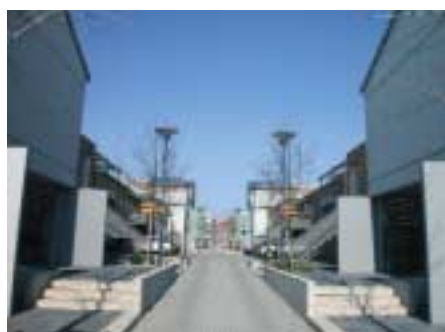
Sichere Wege im Quartier durch die Beleuchtung: 4m Höhe, gegenüberstehende Lampen und gute Sichtbeziehungen
